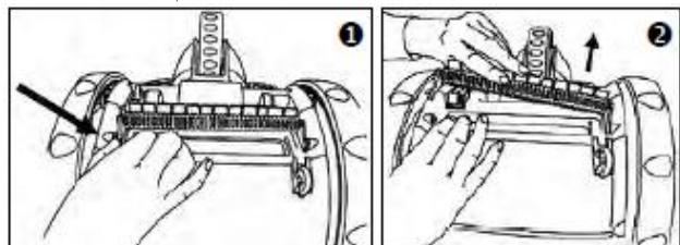
Робот имеет щетки ПВХ с индикаторами износа. Для эффективности чистки необходимо заменять щетки пылесоса при показании индикатора. Переверните очиститель для доступа к щетке. Нажмите на «руку» щетки, чтобы извлечь вал из корпуса (1). Поднимите щетку и удалите ее из фильтра (2). Установите на вал новую щетку.
